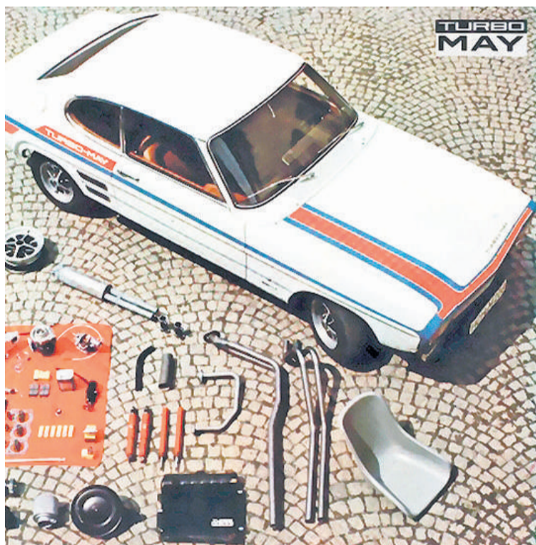
Mit der Turbo-May-Aufladung hatte ein 2.3-L-Ford Capri neu 180 PS.
